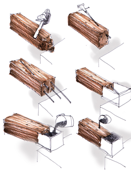
Figura 4 – Consolidação de madeira utilizando uniões entalhadas
