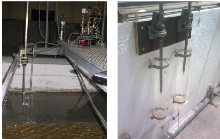
Figura 3 – Tubo de Pitot e equipamento de calibração.
