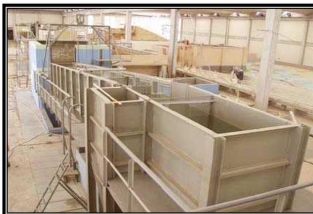
**Figura 10** – Instalação experimental para o estudo de passagem de peixes
