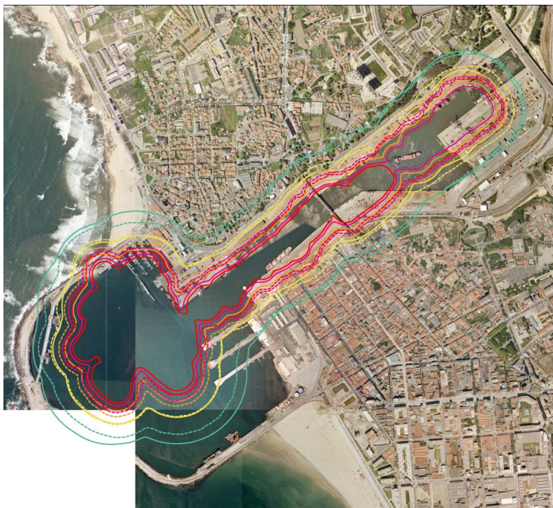
Figura 6 - Linhas de iso-velocidade correspondentes à equação PPV_{50\%} = 1904 R^{-1.46} W^{0.31} (a cheio) e à rede neuronal (a traço interrompido)
