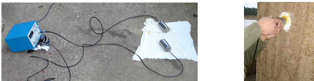
Figura 5: Ensaio de ultra-sons realizado num dos pilares da torre das tomadas de água da barragem do Cabril.
