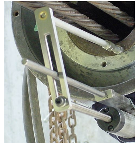
Fig. 8 – Pormenor da montagem do transdutor de deslocamento sobre o actuador.
