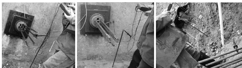
Figura 9 – Medição da resistência eléctrica
