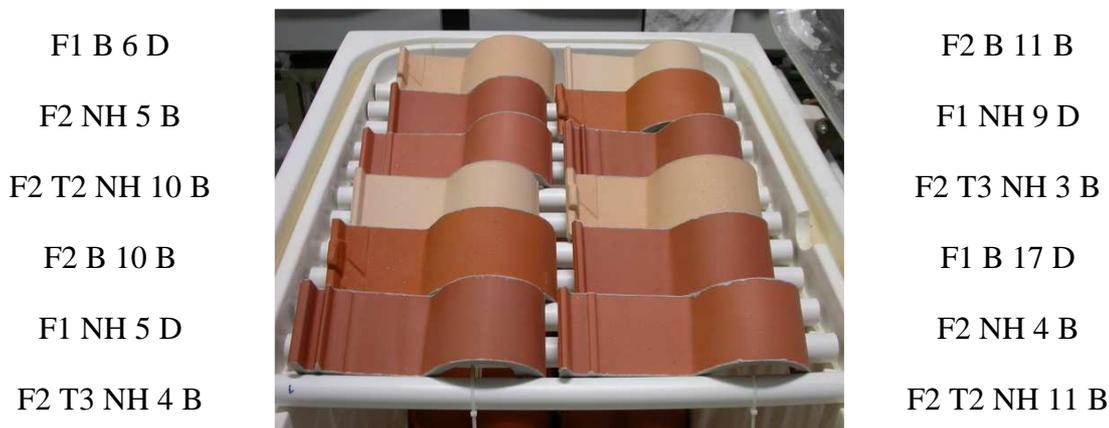
Figura 115 - Provetes submetidos ao ensaio composto
