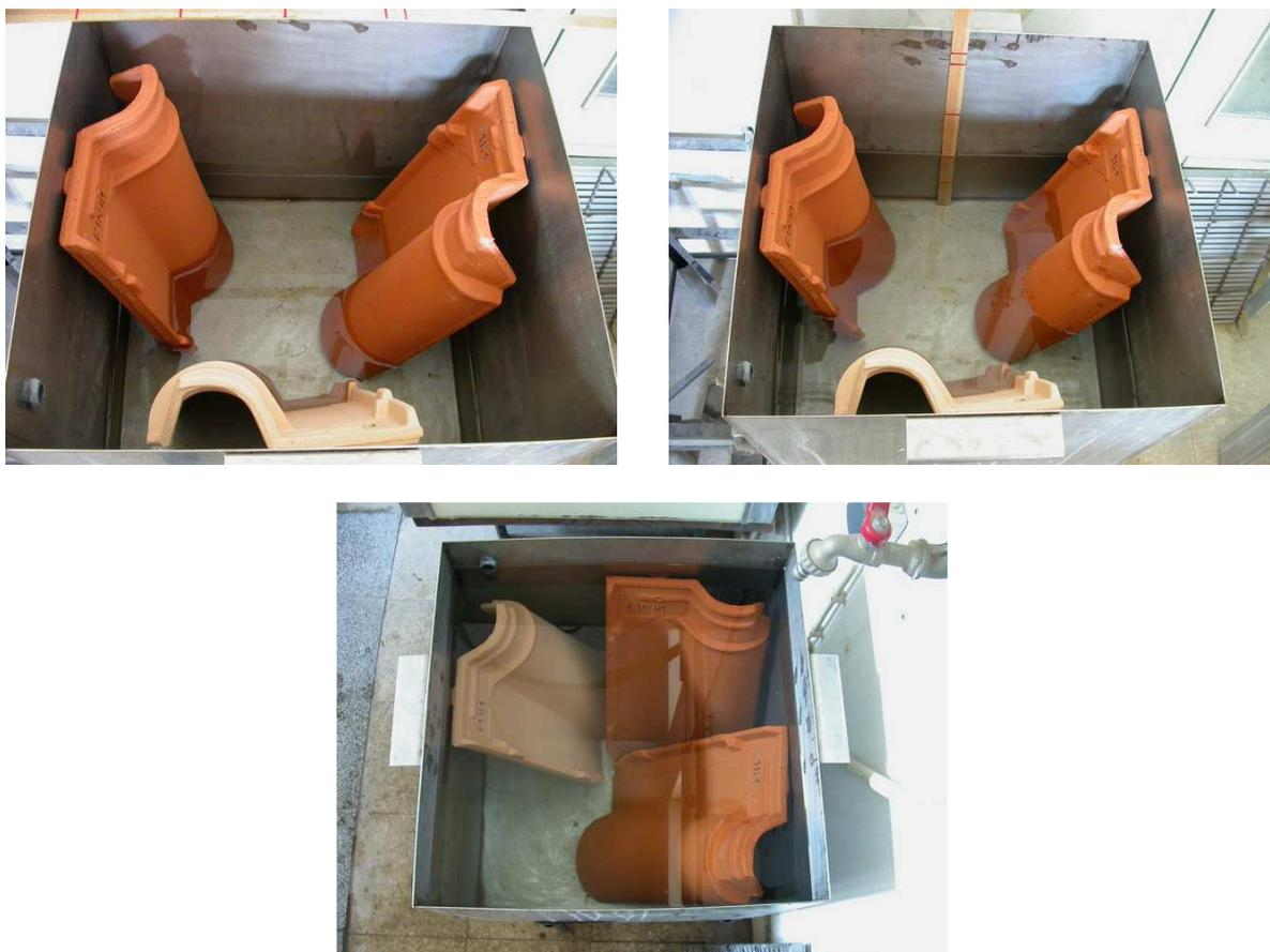
Figura 31 - Ensaio de absorção de água fria por imersão de telhas
