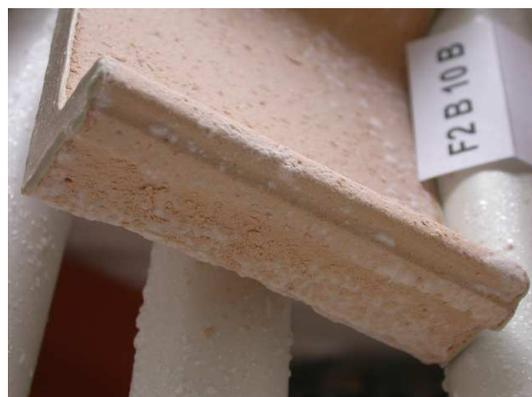
Figura 157 - Pormenor do provete F2 B 10 B após secagem da fase 4
