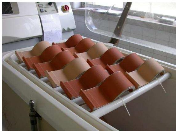
Figura 87 - Montagem dos provetes na câmara de nevoeiro salino
