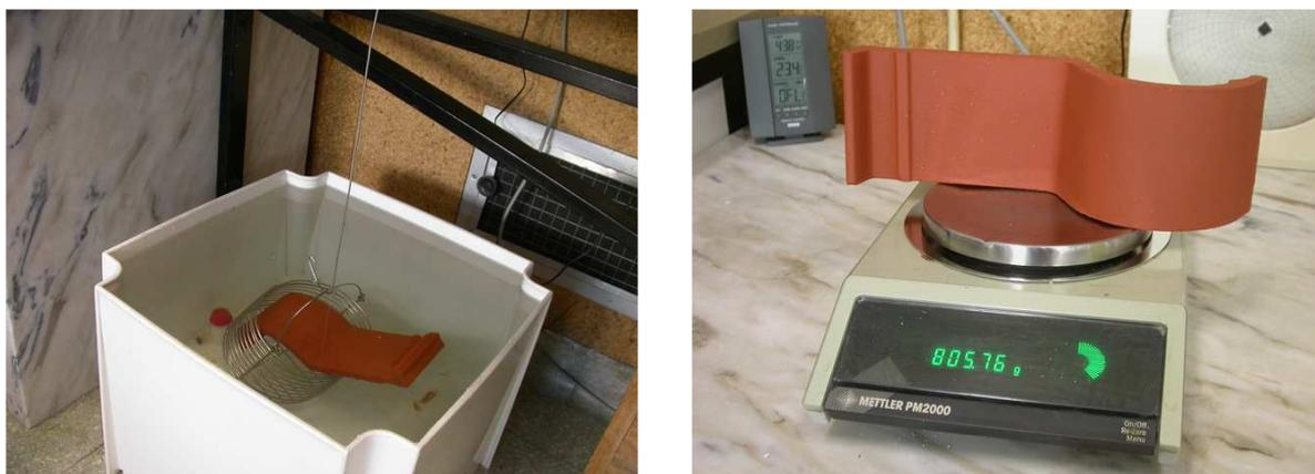
Figura 39 - Pesagem hidrostática e pesagem ao ar
