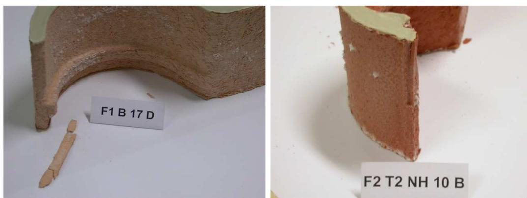
Figura 160 - Provetes F1 B 17 D e F2 T2 NH 10 B após pincelagem a seco da fase 4
