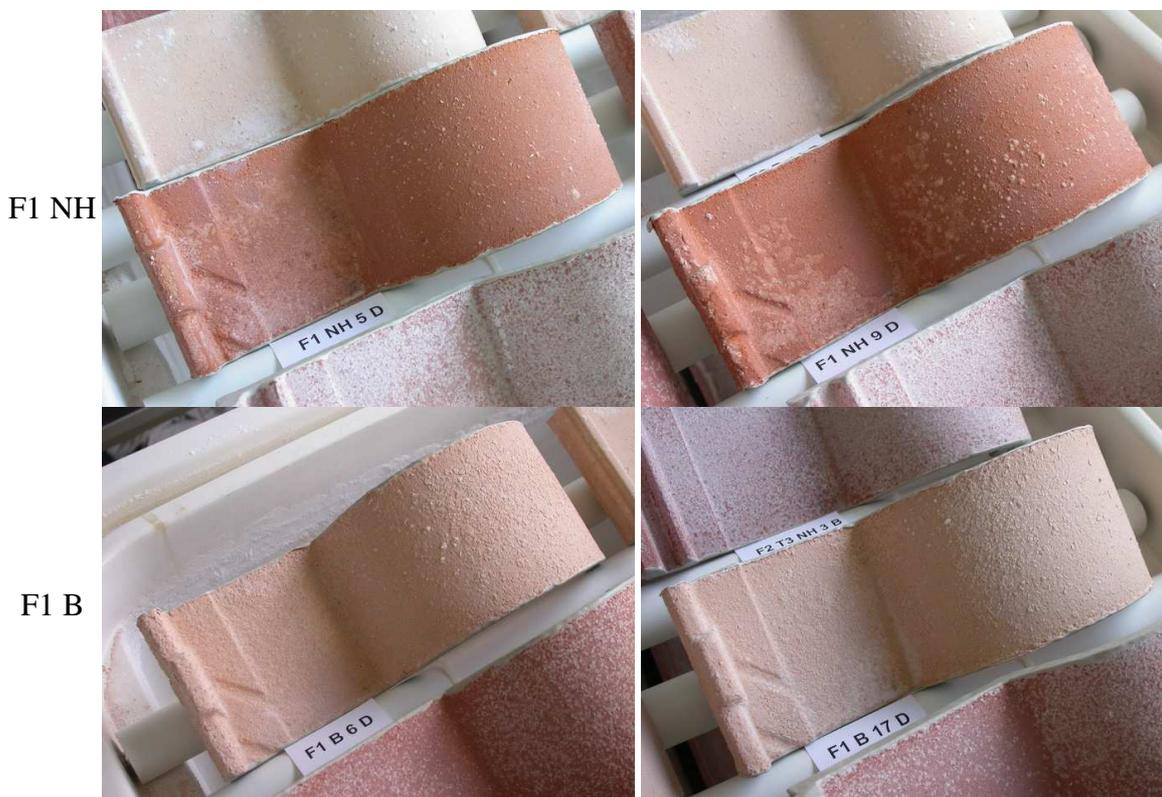
Figura 128 - Provetes do fabricante 1 após secagem da fase 2
