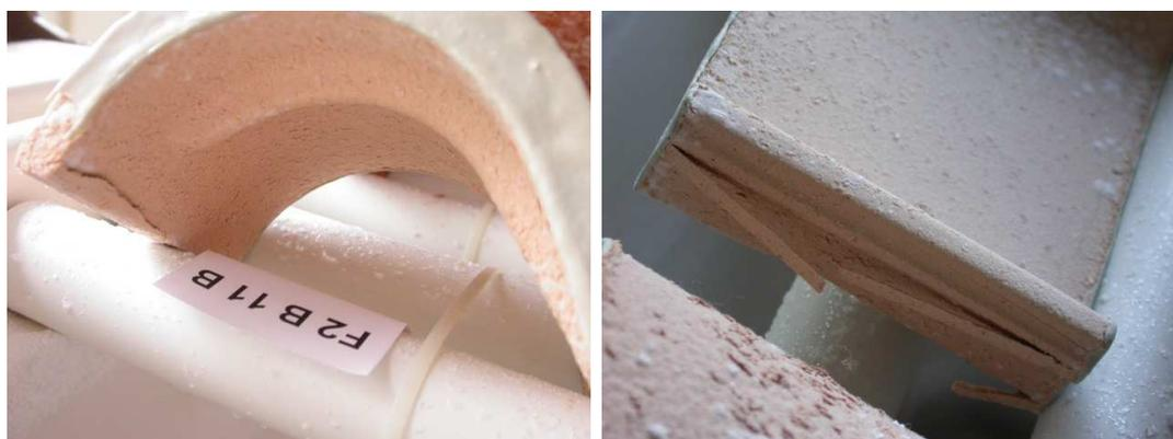
Figura 158 - Degradação localizada do provete F2 B 11 B após secagem da fase 4
