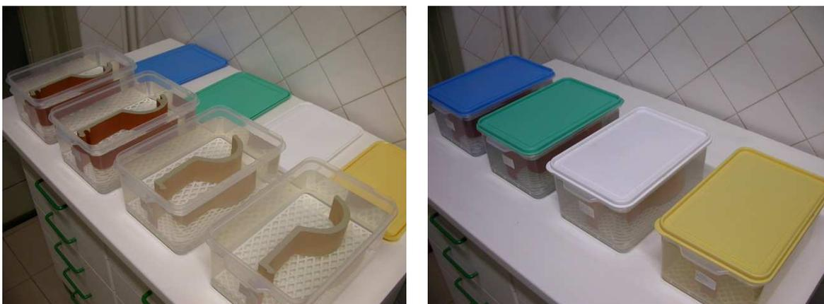
Figura 169 - Dessalinização de provetes sujeitos a nevoeiro salino
