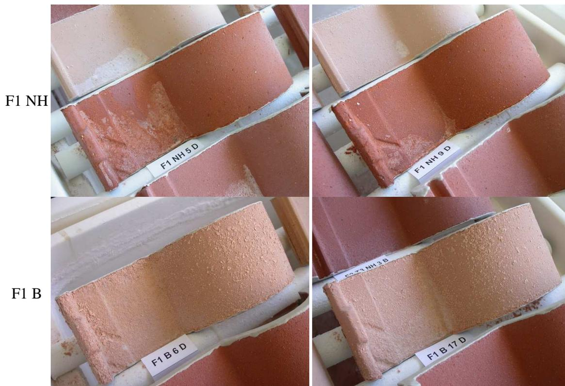
Figura 130 - Provetes do fabricante 1 após 11 ciclos de nevoeiro/secagem da fase 3
