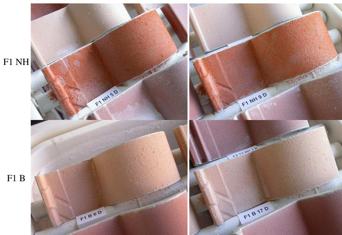
Figura 116 - Provetes do fabricante 1 após 13 ciclos de nevoeiro/secagem da fase 1
