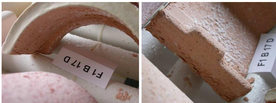
Figura 156 - Aspectos da degradação do provete F1 B 17 D após secagem da fase 4
