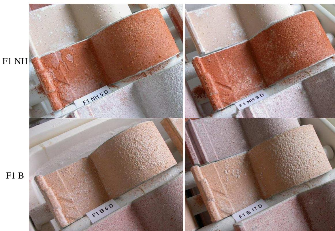
Figura 119 - Provetes do fabricante 1 após secagem da fase 1
