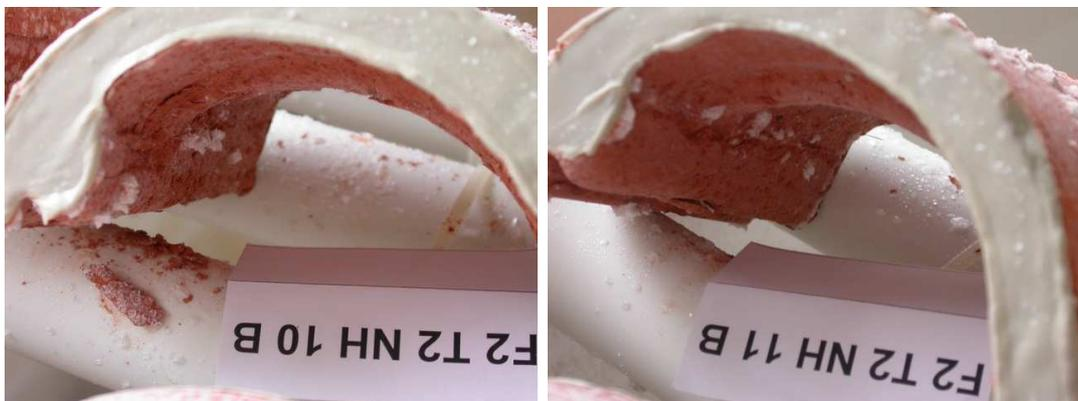
Figura 159 - Pormenor da face inferior do canudo dos provetes F2 T2 NH após secagem da fase 4
