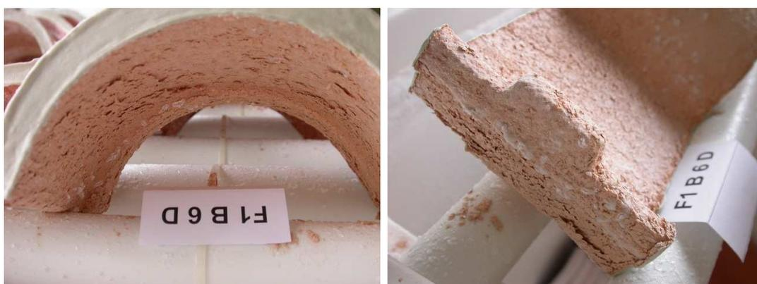
Figura 155 - Aspectos da degradação do provete F1 B 6 D após secagem da fase 4
