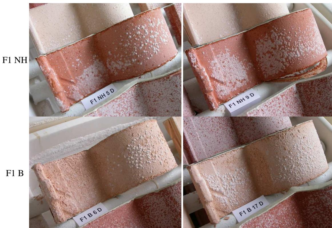
Figura 152 - Provetes do fabricante 1 após secagem da fase 4
