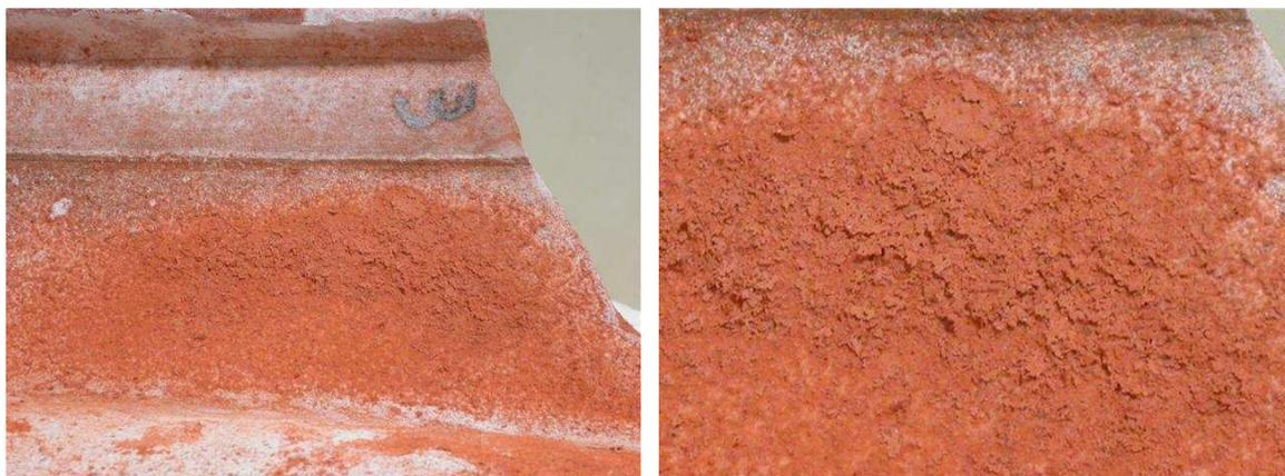
Figura 77 - Degradação na aba do provete T3 após ensaio preliminar 1
