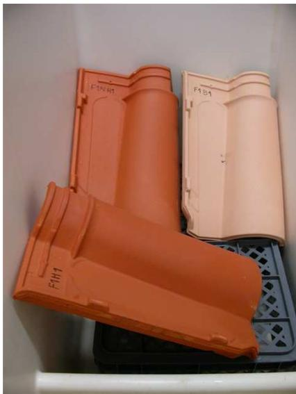
Figura 62 - Telhas do fabricante 1 antes do ensaio de nevoeiro sem sal
