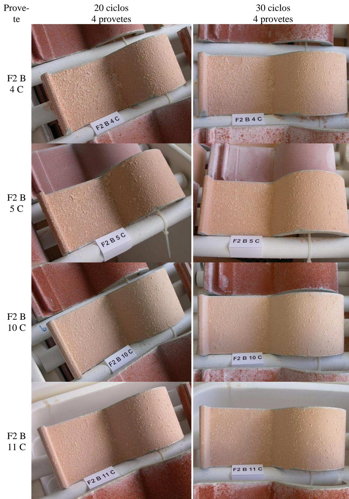
Figura 113 - Provetes F2 B submetidos a 30 ciclos após 20 e 30 ciclos de nevoeiro salino seguido de secagem
