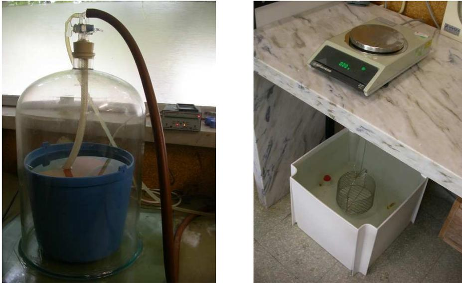
Figura 38 - Imersão em água sob vácuo e balança hidrostática
