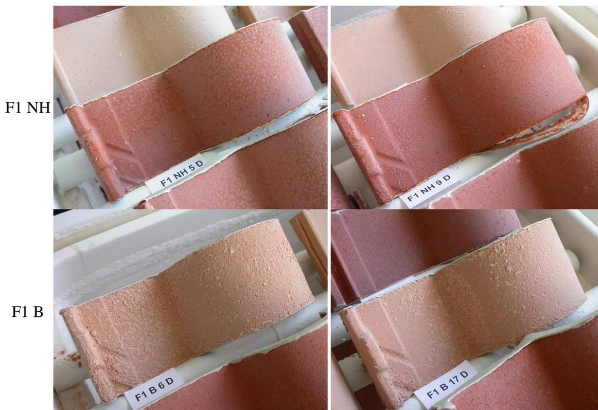
Figura 146 - Provetes do fabricante 1 após 15 ciclos de nevoeiro/secagem da fase 4
