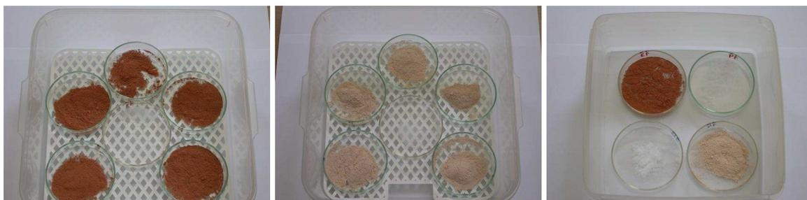
Figura 188 - Camadas reduzidas a pó e amostras de controlo
