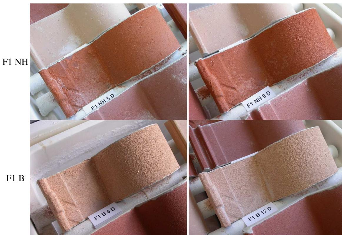
Figura 121 - Provetes do fabricante 1 após 10 ciclos de nevoeiro/secagem da fase 2
