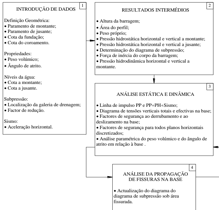
Figura 4 – Diagrama de funcionamento da aplicação numérica desenvolvida para a análise limite de barragens gravidade
