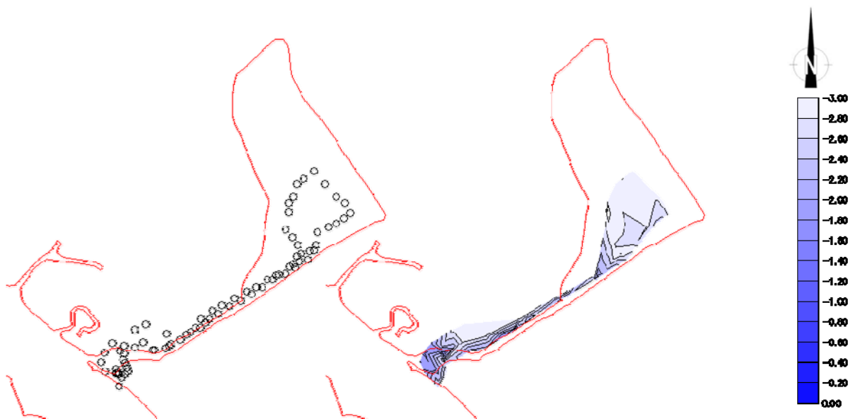
Figura 5 – Levantamento topo-hidrográfico da zona de sapal: a) Pontos de levantamento; b) Isolinhas de batimetria (em m, referidas ao ZH).
