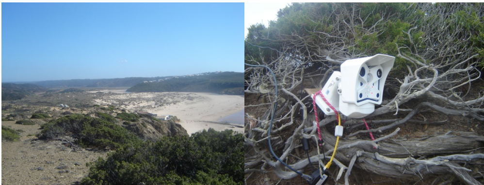
Figura 28 – Instalação da câmara de vídeo-monitorização (à esquerda local de instalação; à direita pormenor da câmara de vídeo).
