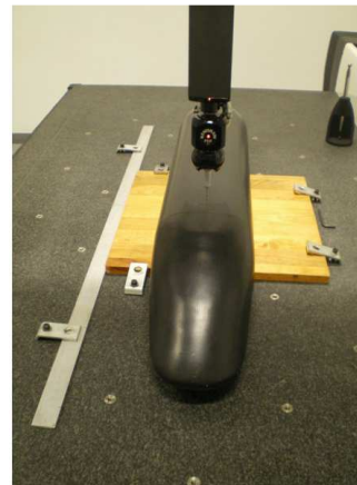
Figura 2 – Instalação da base e do modelo na mesa-plano
