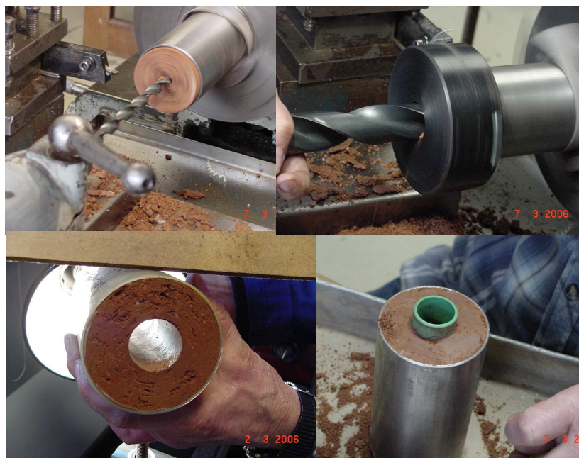
Figura 2 - Cravação do amostrador metálico com o diâmetro correspondente ao diâmetro exterior final e realização do furo interior
