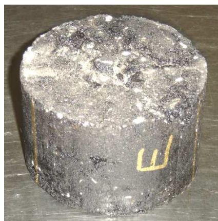
Figura 2.3: Provede cilíndrico para ensaio Marshall.
