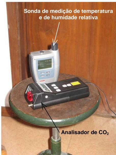
**Fig. 8** – Equipamentos de medição e de registo em contínuo do CO<sub>2</sub>, da temperatura e da humidade relativa do ar.
