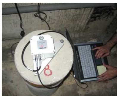
Figura 4 – Instalação do clinómetro: programação do computador.
