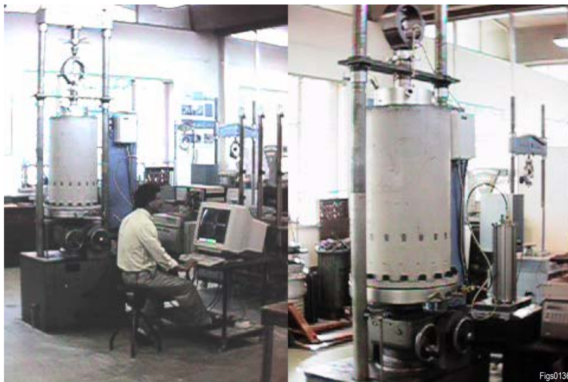
Fig. 3.21 - Equipamento para ensaios triaxiais de enrocamento
