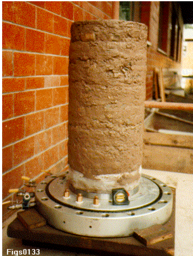
Fig. 3.28 - Aspecto final do provete do ensaio triaxial T1
