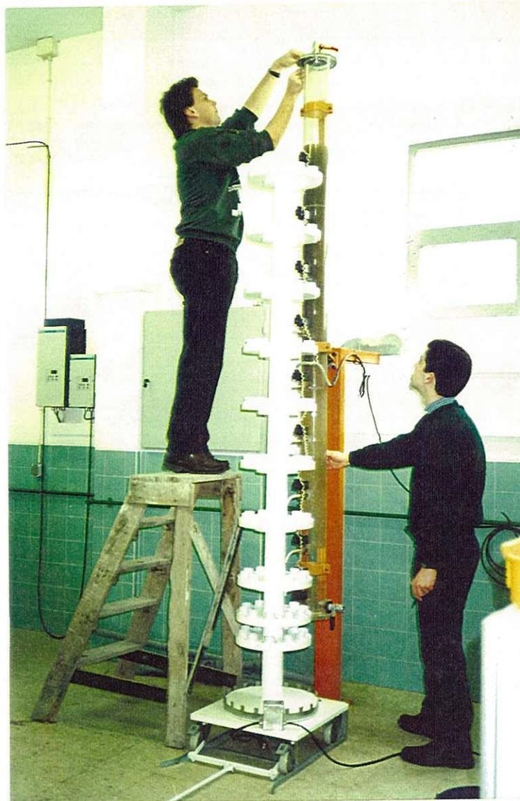
Fotografia XXXI - Aspecto da coluna de sedimentação da Estação Experimental de Sedimentos Coesivos do LNEC.
