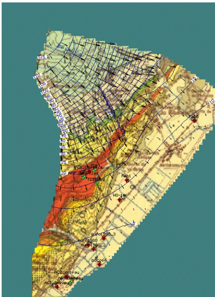
Figura 8 – Resultados do modelo em estado estacionário (nível piezométrico em metros e linhas de fluxo)
