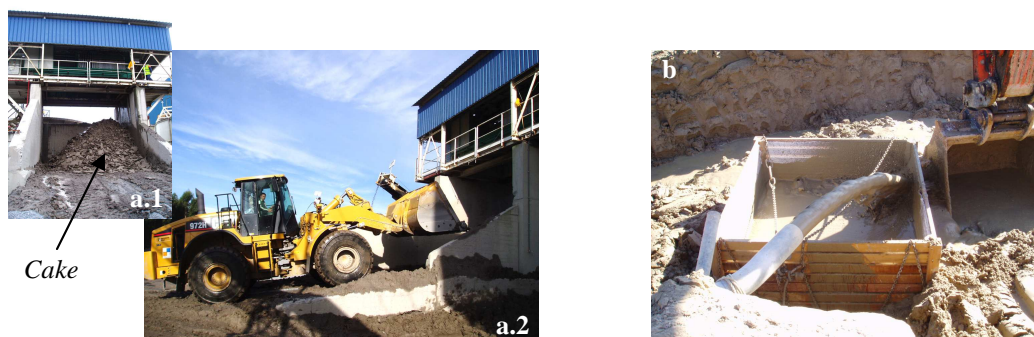
Figura 1 – Amostragem nas duas pedreiras de granito: a.1) cake da Pedreira do Moinho de Vento (Famalicão) e a.2) amostragem em pá de retro-escavadora na mesma pedreira; b) recolha de finos na Pedreira da Bouça do Menino (Cervães).
