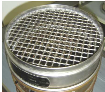
Figura 2.1: Exemplo de peneiro de malha metálica utilizado pelo LNEC/PAVMAT.
