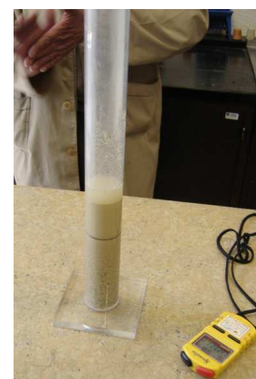
Figura 4.2: Período de repouso inicial do provete no interior da proveta contendo a solução floculante.
