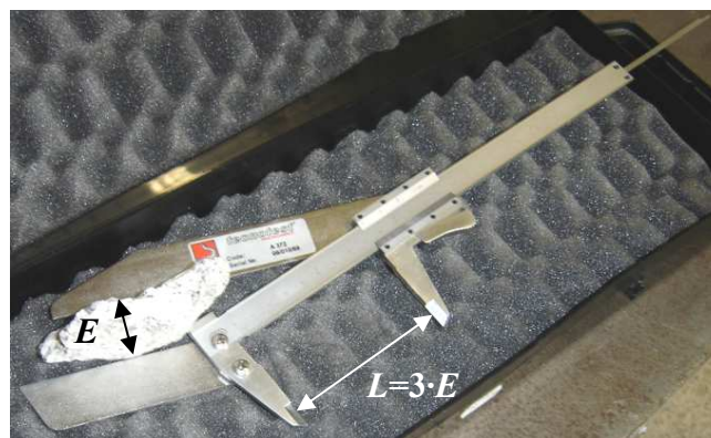
Figura 3.1: Paquímetro utilizado pelo LNEC/PAVMAT no ensaio de determinação do índice de forma.
