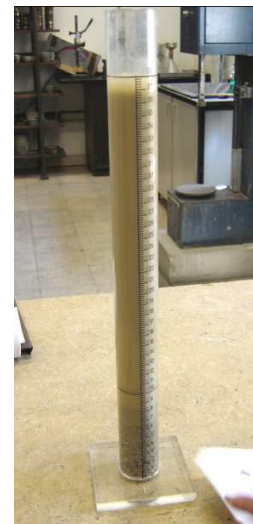
Figura 4.1: Proveta cilíndrica graduada utilizada pelo LNEC/PAVMAT.
