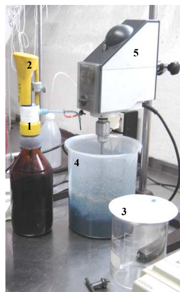
Figura 5.1: Montagem experimental do ensaio do azul de metileno.
