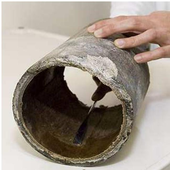
**Figura 2.** Colheita de amostras de biofilme para estudo no LNEC.
