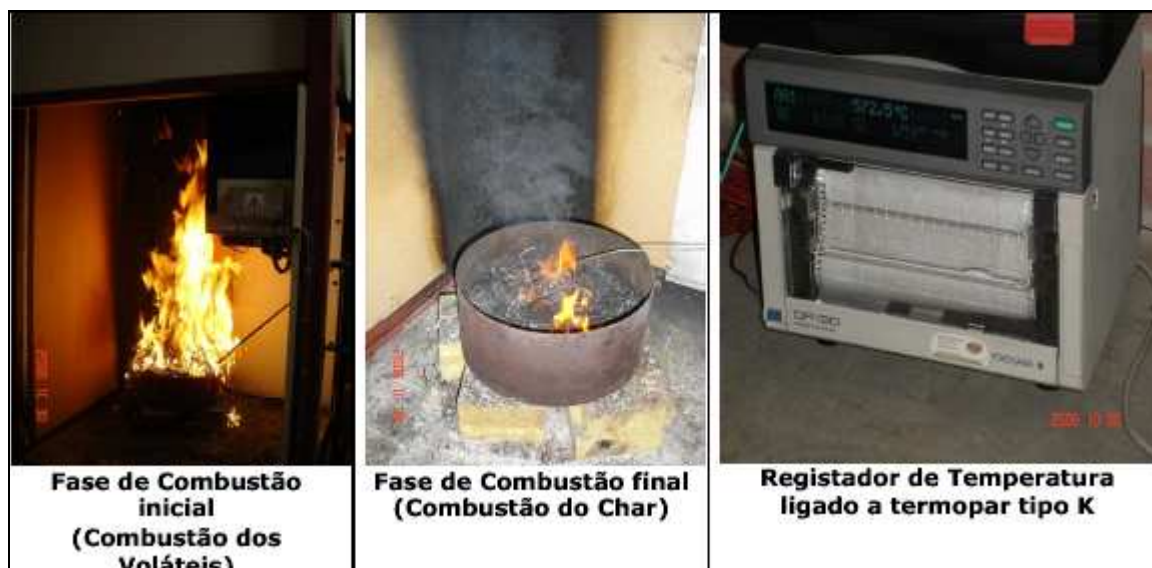
Fig. 61 - Ensaio de Combustão de biomassa arbustiva no LNEC/LERF
