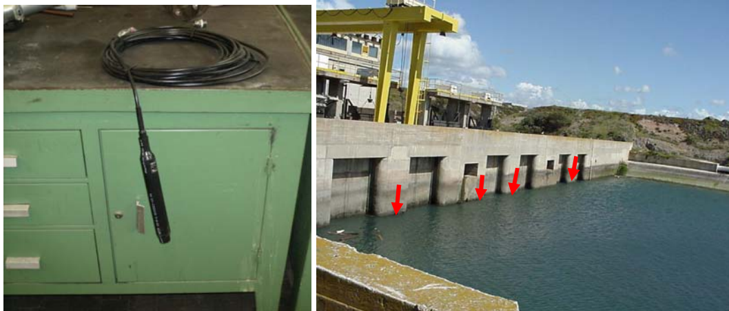
Figura 3: a) Sensor de pressão hidrostática; b) Local de montagem dos sensores (4 sensores, 1 por grupo).
