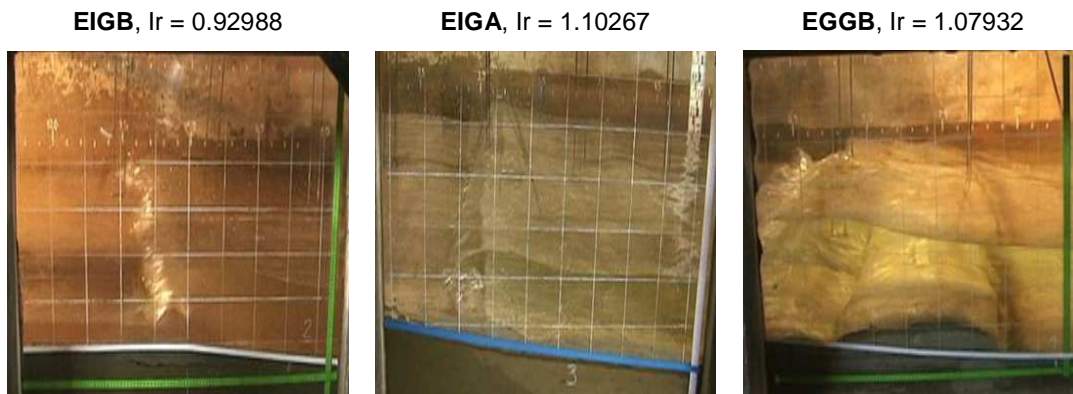
Figura 11. Rebentação observada nos ensaios para h = 0.75 m, H = 0.10 m e T = 2.84 s.
