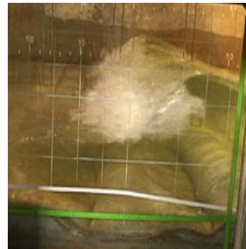
Figura 13. Rebentação observada nos ensaios para h = 0.87 m, H = 0.20 m e T = 2.52 s.
