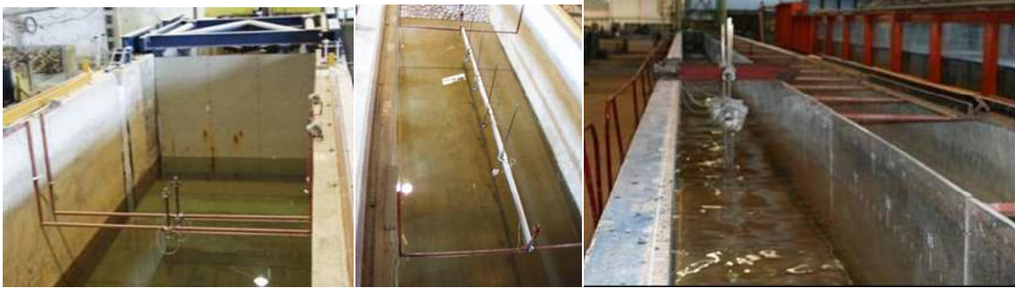
Figura 7. Duas sondas junto ao batedor (esq.); Quatro sondas ao longo do canal (centro) – COI2; Seis sondas ao longo do canal – COI1 (dir.).
