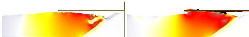
Figura 7. Aspecto da superfície livre para: NM,  $T = 1.69$  s e  $H = 0.09$  m (esquerda) e PM,  $T = 2.37$  s e  $H = 0.11$  m (direita)
