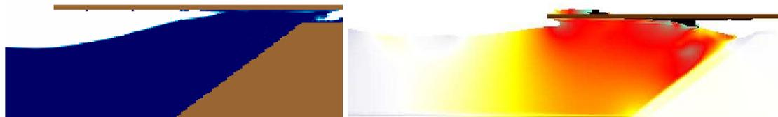
Figura 4. Aspecto da superfície livre calculada pelo modelo COBRAS-UC para o caso de talude impermeável (esquerda) e poroso (direita) para preia-mar,  $T = 1.69$  s e  $H = 0.11$  m.
