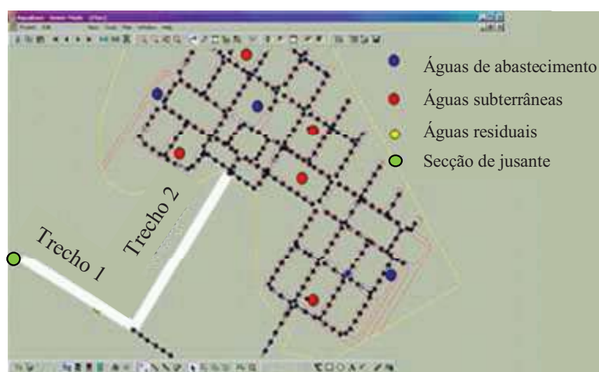
Figura 5.13 – Esquema do sistema de drenagem da bacia de Torraccia e pontos de medição
