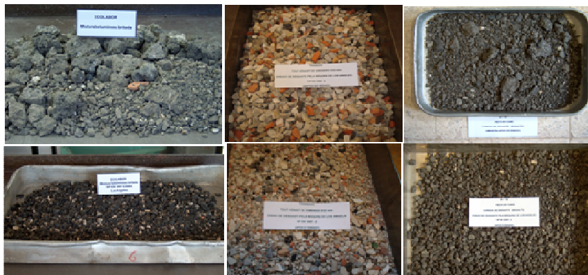
Figura 4 – Aspecto das amostras de agregados reciclados, antes e após o ensaio de resistência à fragmentação – ensaio de Los Angeles
