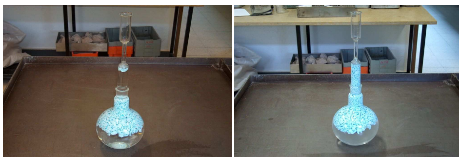
Figura 3 – Determinação das massas volúmicas e absorção de água das amostras RCD-LEVE
