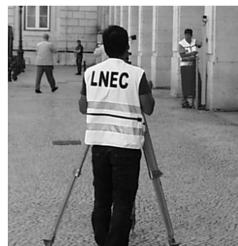
Figura 7 – Leitura para a mira estacionada no ponto 6
