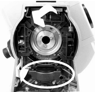
Figura 5 – Interior do TCA com indicação da localização do depósito de óleo
