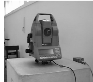
Figura 3 – Taqueómetro Leica TCA2003
