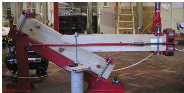
Figura 3.70 - Vista geral de um ensaio de uma ligação com braçadeira metálica
