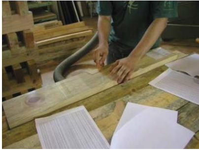
Figura 3.13 - Marcação das peças para corte dos entalhes
