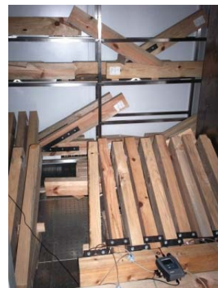
Figura 3.4 - Ligações na câmara de condicionamento
