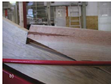
Figura 3.36 - Sequência (ligação 5.1): a) início do ensaio ; b) fim do ensaio
