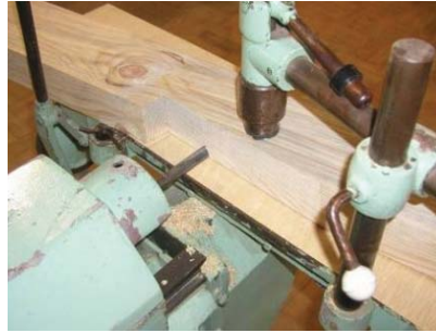
Figura 3.14 - Execução da mecha
