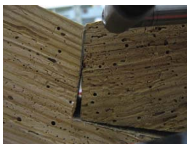
Figura 3.86 - Pormenor (ligação 34.3): área de contacto, na face frontal do entalhe, vai-se reduzindo (idêntico aos outros ensaios com t_v = 45\text{ mm} )
