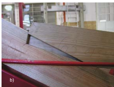
Figura 3.49 - Sequência (ligação 11.2): a) início do ensaio; b) fim do ensaio
