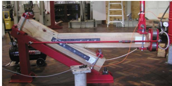
Figura 3.51 - Vista geral de um ensaio de uma ligação com esquadros metálicos
