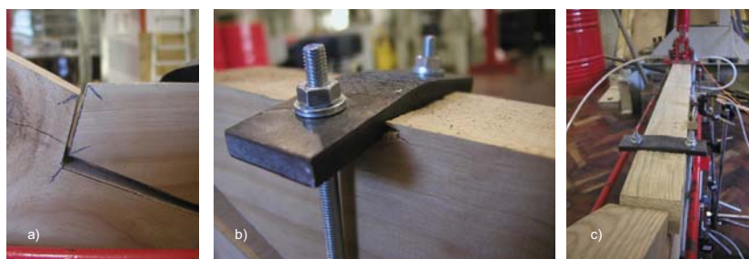
Figura 3.79 - Pormenores: a) perda de contacto na face frontal do entalhe; b) esmagamento da madeira sob a chapa espessa; c) instabilização lateral da perna.
