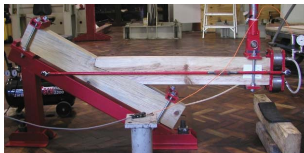
Figura 3.38 - Vista geral de um ensaio de uma ligação com respiga
