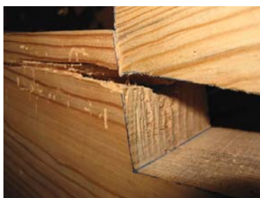
Figura 3.89 - Pormenor (ligação 35.2): rotura, por tracção perpendicular, do troço da linha após o entalhe
