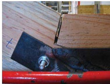
Figura 3.69 - Pormenor (ligação 20.3): folga entre as faces no entalhe
