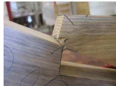
Figura 3.37 - Pormenor (ligação 5.2): rotura localizada da madeira no fim do ensaio
