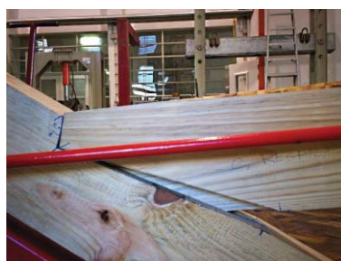
Figura 3.47 - Pormenor (ligação 10.1): redução da área de contacto na face frontal do entalhe
