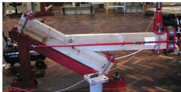
Figura 3.20 - Vista geral de um ensaio de uma ligação simples
