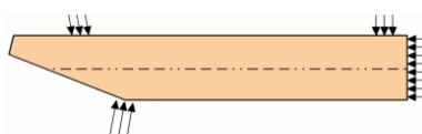
Figura 3.77 - Diagrama de corpo livre da perna, nos ensaios de fechar o ângulo
