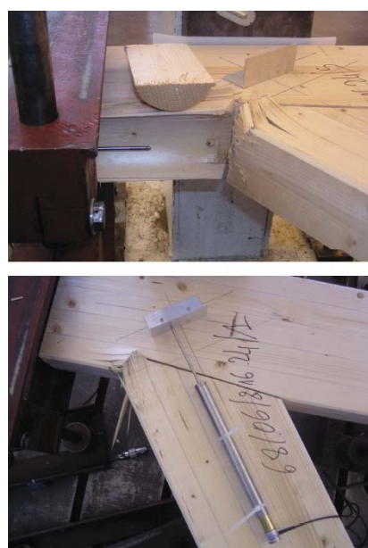
Figura 2.20 - Exemplos de roturas (Faye 2007)
