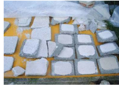
Fig. 89, Diversas amostras de marmorite para o restauro da fachada do Edifício Principal do LNEC
