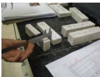
Fig. 407, O provete depois da secagem; medição da retracção da Argamassa de grout
