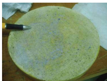
Fig. 249, Acril a 75% após aplicação no provete
