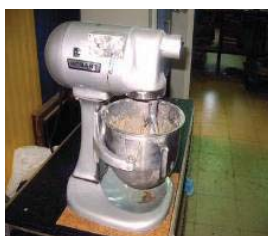
Fig. 232, Preparo da argamassa em laboratório
