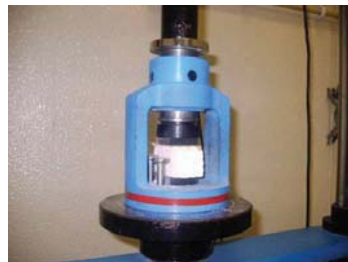
Fig. 263. O ensaio de resistência à flexão.
