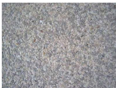
Fig. 79, Pormenor da marmorite do LNEC, observa-se o jogo cromático e de vibrações dos distintos agregados.
