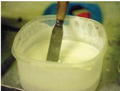
Fig. 421, Aspecto final da caiação de cal em pó
