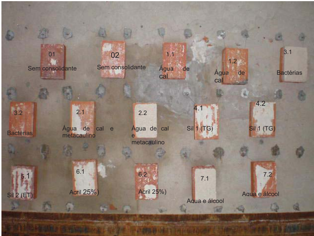
Fig. 271, Vista geral dos provetes na câmara após o último ciclo chuva/gelo
