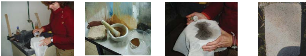
Fig. 450, Execução da velatura (acqua sporca) para a marmorite das fachadas do Edifício Principal do LNEC, experiência em laboratório
