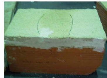
Fig. 405, O provete após a injeção com a Calda de cal
