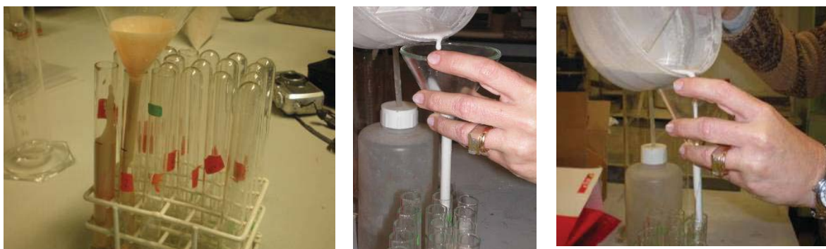
Fig. 408, Ensaio para verificar a exsudação das argamassas de grout
