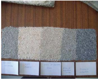
Fig. 87, Escolha dos agregados para a marmorite de reparação da fachada do Edifício Principal do LNEC
