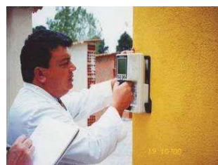
Fig. 184, Medição da cor com espectocolorímetro, Estação de ensaio do LNEC.
