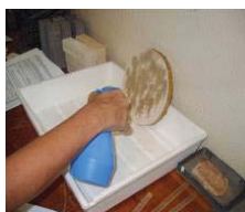
Fig. 251, Aplicação através da técnica da pulverização
