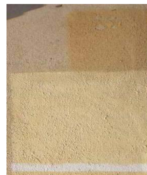
Fig. 448, Muretes após 8 anos de envelhecimento natural
