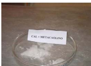
Fig. 239 , Resíduo da água de cal em forma de placas na solução Água de cal + Metacaulino
