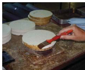
Fig. 234, Impregnação com cera das laterais dos provetes
