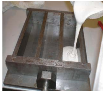
Fig. 391, Enchimento do provete de calda de cal
