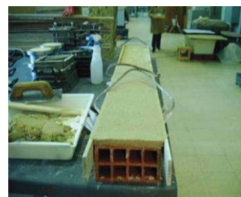
Fig. 231, Provetes de tijolos furados
