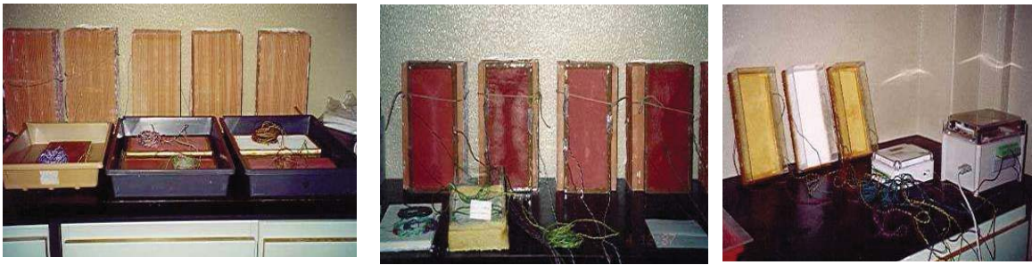
Fig. 436, Diversos aspectos do ensaio com humidímetro
