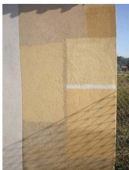
Fig. 449, Muretes pintados com a tinta de silicato D após 1 ano de exposição
