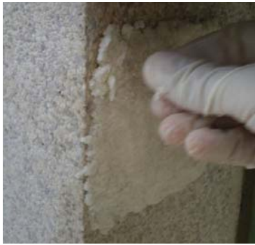
Fig. 202, Ensaio de limpeza com compressas químicas (restauro da fachada do Edifício Principal do LNEC).
