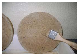
Fig. 252, Aplicação com trincha
