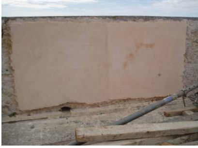
Fig. 222, Argamassa de cal aérea com Metacaulino
