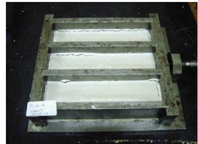
Fig. 392, O provete após introdução da Calda de cal
