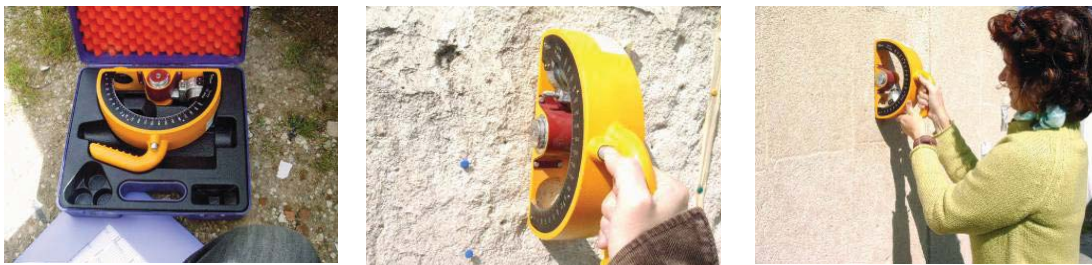
Fig. 366, Esclerómetro de pêndulo, modelo SCHMIDT PM – ensaios sobre muretes e o reboco antigo
