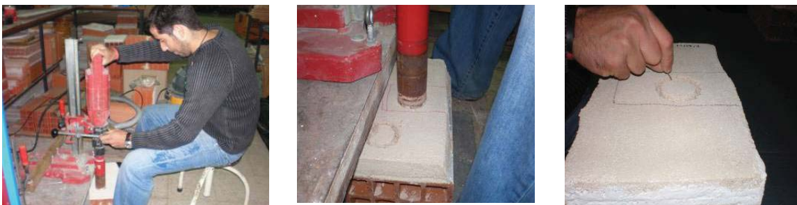
Fig. 411, A furação do provete com carotadora e manualmente
