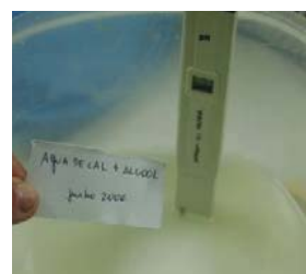
Fig. 241 , Medição do índice do pH da solução de Água de cal + Álcool
