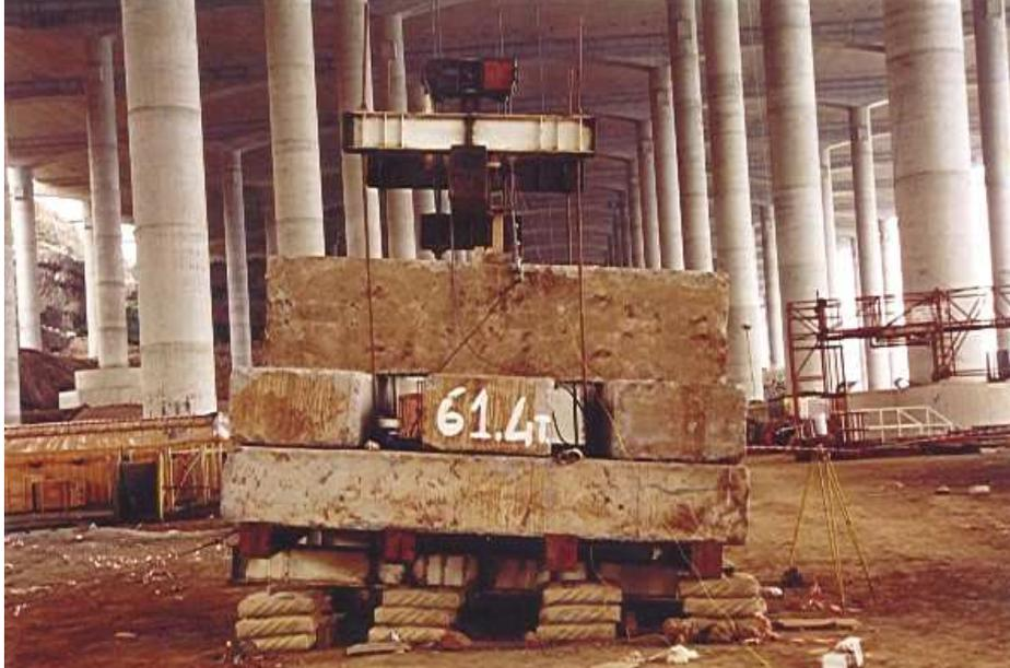
Figura 9 – Ensaios impulsivos no Aeroporto da Madeira: libertação de uma massa
