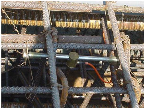
Figura 4 – Extensómetro de corda vibrante
