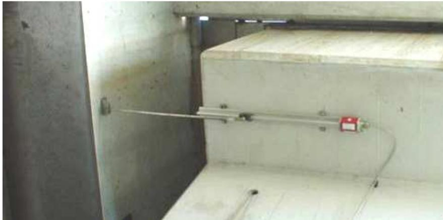
Figura 1 – Medição da abertura de uma junta com um deflectómetro magnetostriectivo
