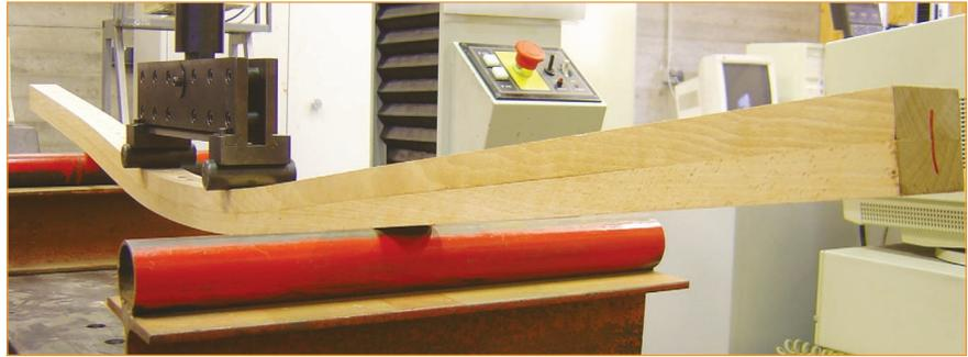
Ensaio de flexão de viga de faia com 2m de comprimento obtida por meio de cavilhas soldadas: flexão máxima antes da rotura.
