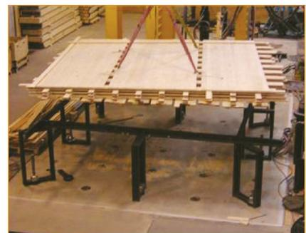
Pavimento sobre-elevado a ser colocado na plataforma de ensaio.
