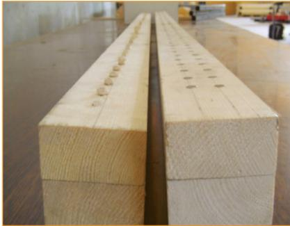
Vigas com 2m de comprimento obtidas pela ligação de duas lamelas por meio de cavilhas de madeira soldadas (uma e duas fiadas).
