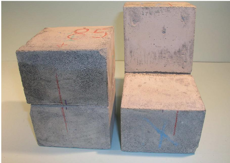
**Figura 1 – Aspecto de um provete com junta e da superfície de uma junta**
