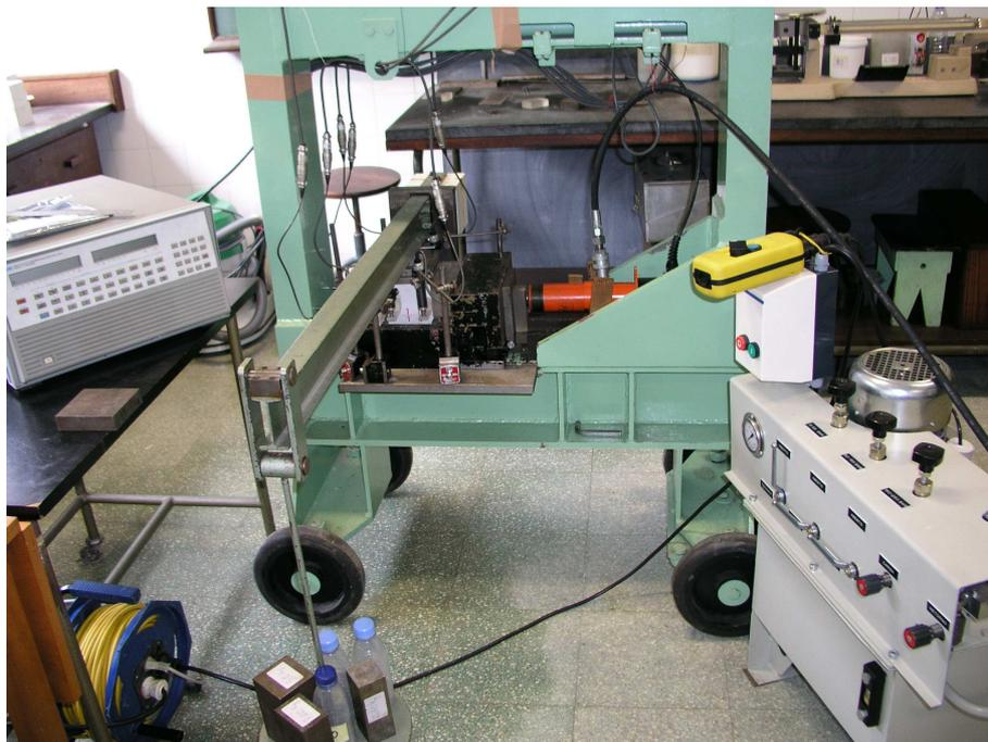
**Figura A1 – Equipamento para a realização de ensaios de juntas**
