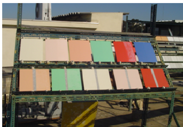
Figura 10 - Provetes expostos no terraço do LNEC
