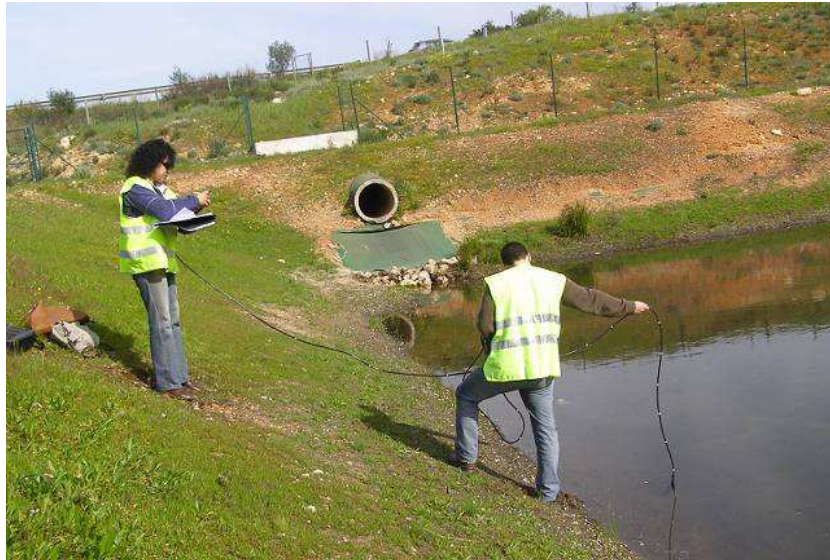
Fig. 11 - Medições com sonda multiparamétrica na bacia de retenção BTA-8 (Lanço Alcantarilha - Guia)
