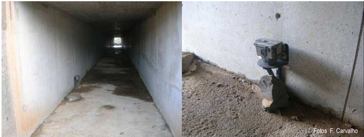
Fig. 76 - Exemplo de uma câmara fotográfica colocada na passagem hidráulica (A), pormenor da máquina colocada a 30 cm do chão (B)
