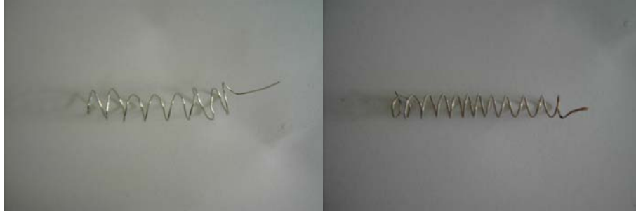
Figura 27: Aspecto do aço inoxidável antes (esquerda) e após imersão (direita)
