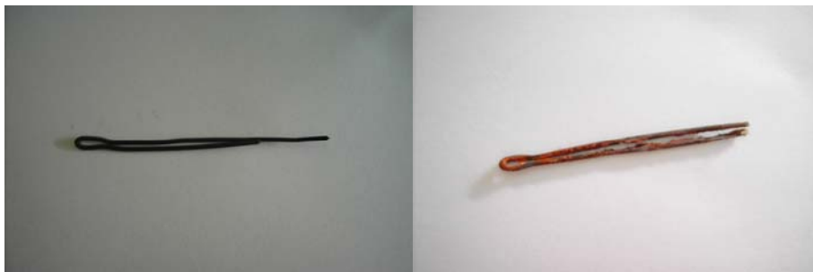
Figura 28: Aspecto do aço de construção antes (esquerda) e após imersão (direita)
