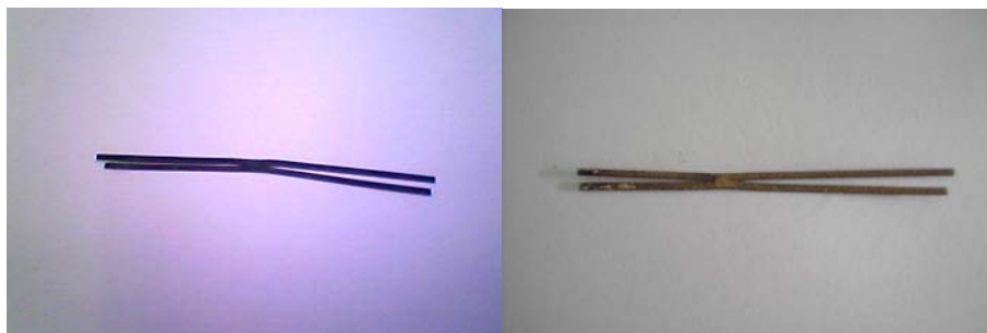
Figura 26: Aspecto d e um eléctrodo do titânio antes (esquerda) e após imersão (direita)
