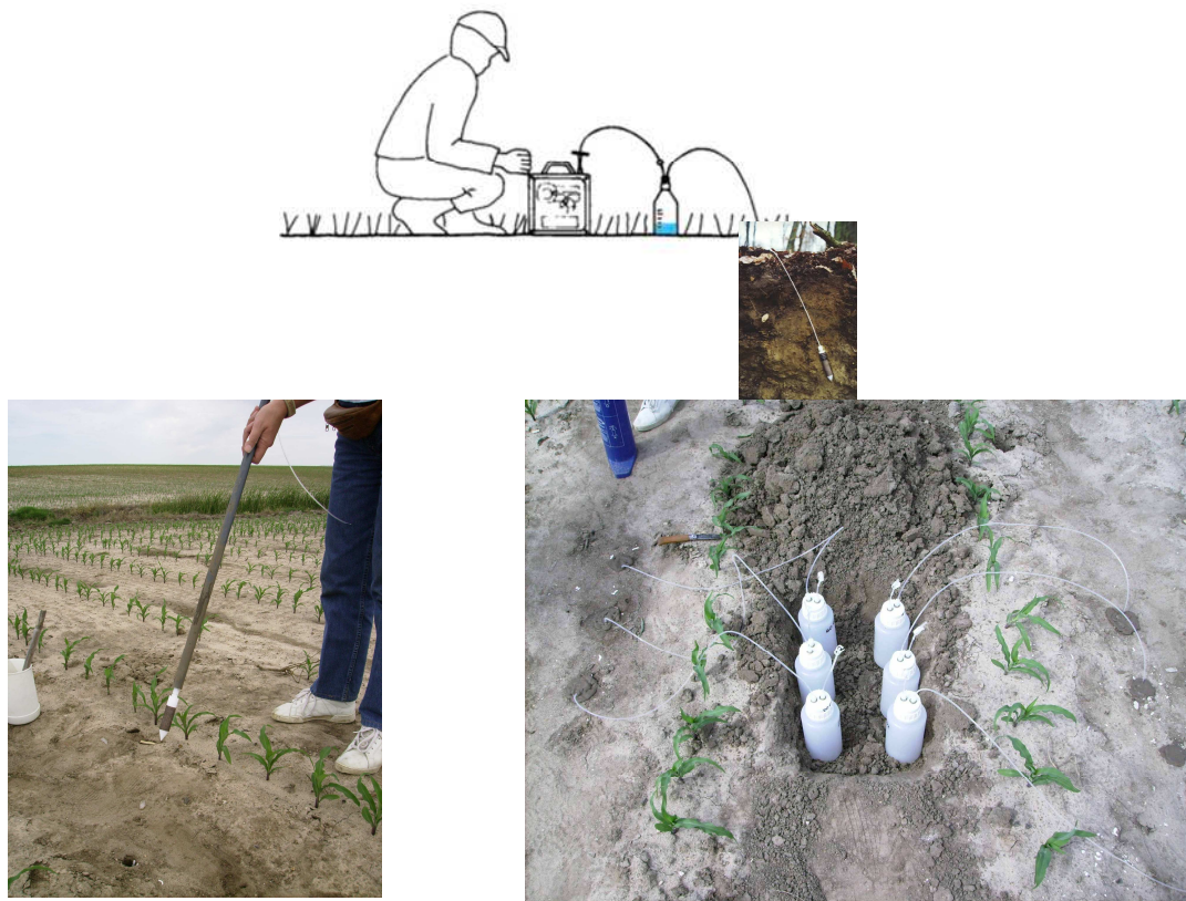
Fig. 12 - Instalação das cápsulas de Teflon® no Monte da Mancoca
