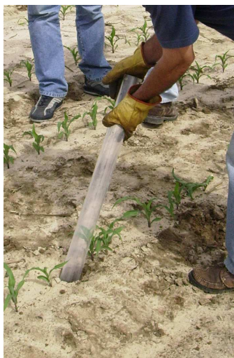
Fig. 7 - Tubo de acesso para o minirizotróo, em acrílico
