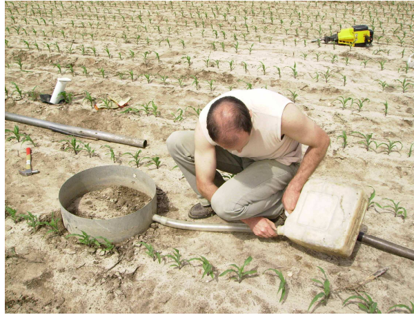
Fig. 11 - Anel de escorrência para amostragem de água superficial no Monte da Mancoca
