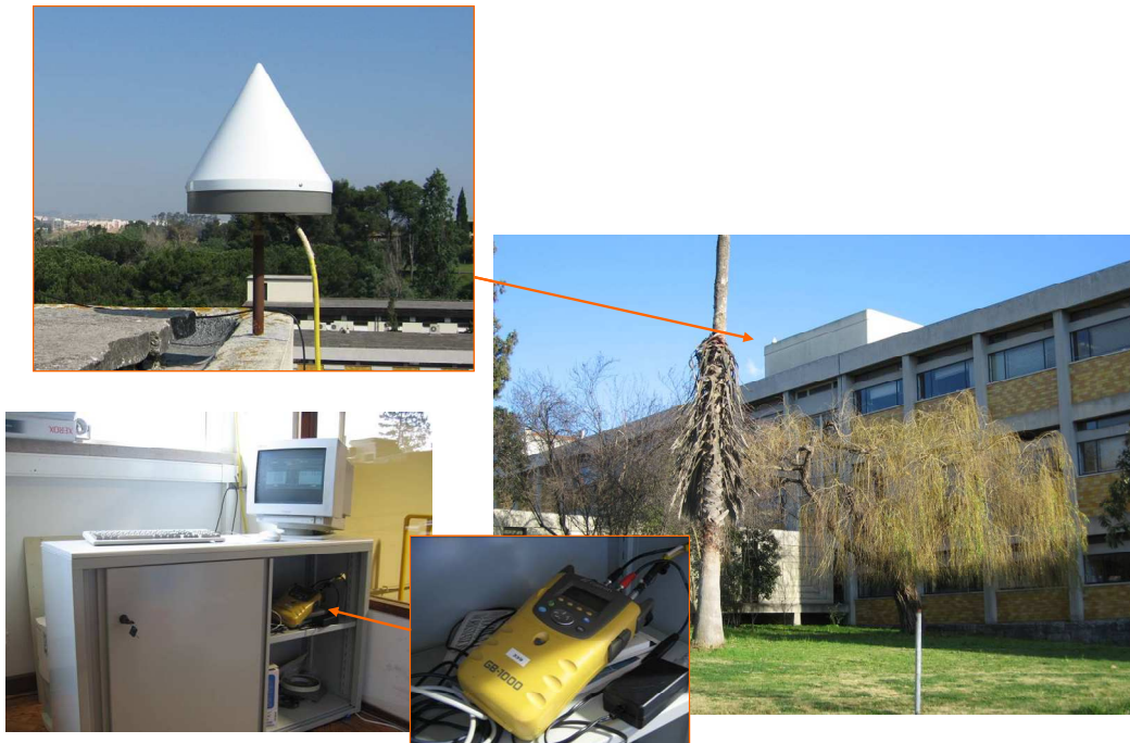
Figura 1 – Estação GNSS semi-permanente do LNEC (DBB).
