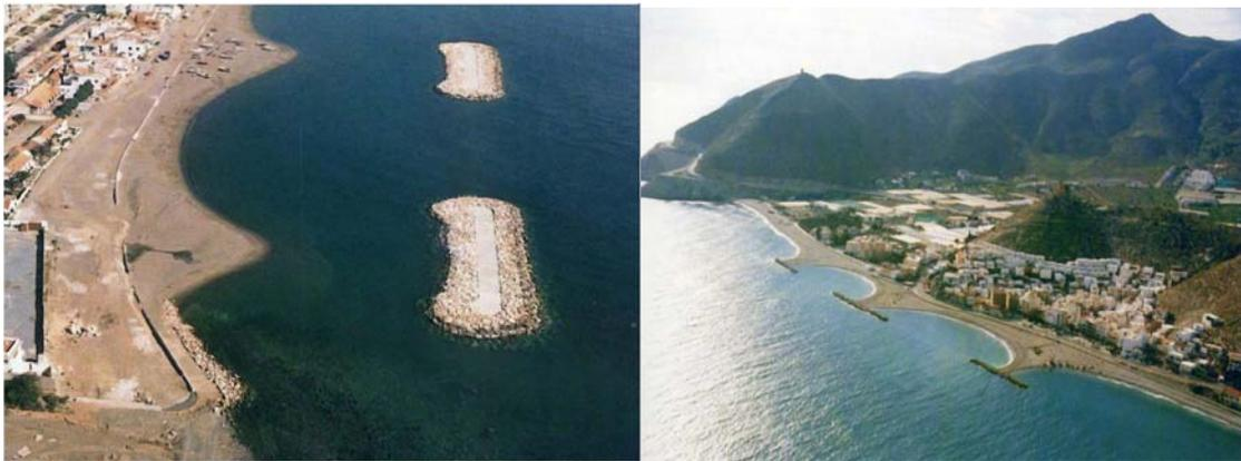
Fig. 1 – Quebra-mares destacados com formação de salientes e tómbolos
