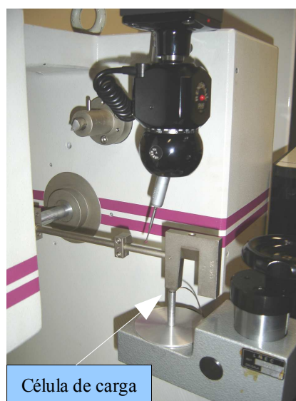
Figuras 4 e 5: Representação esquemática e experimental da determinação do momento de rotação do pêndulo.
