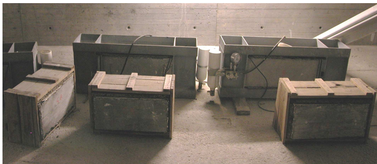
Figura 4.18 – Prismas compensadores de retracção e de fluência em ambiente interior
