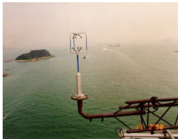
(b) Anemómetro ultra-sónico na Ponte Tsing Ma em Hong-Kong (Wong, 2004)
