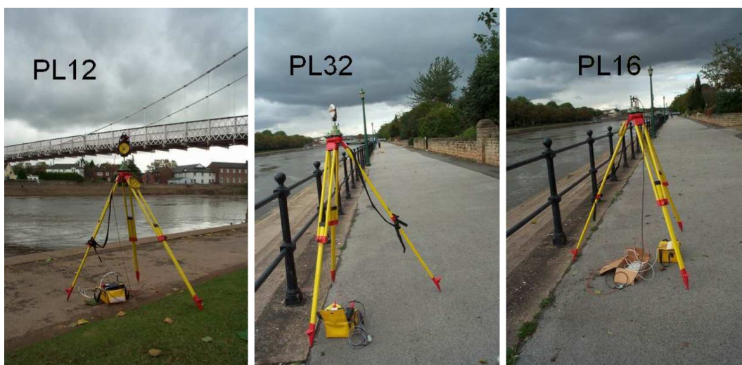
Figura 2.33 – Pseudo-Satélites usados nos ensaios da Ponte Wilford em Nottingham (Barnes et al , 2003a)
