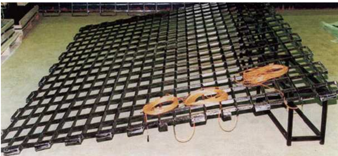
Figura 2.41 – Sensores de Fabry-Perót integrados em PFRC (Tennyson et al , 2001)
