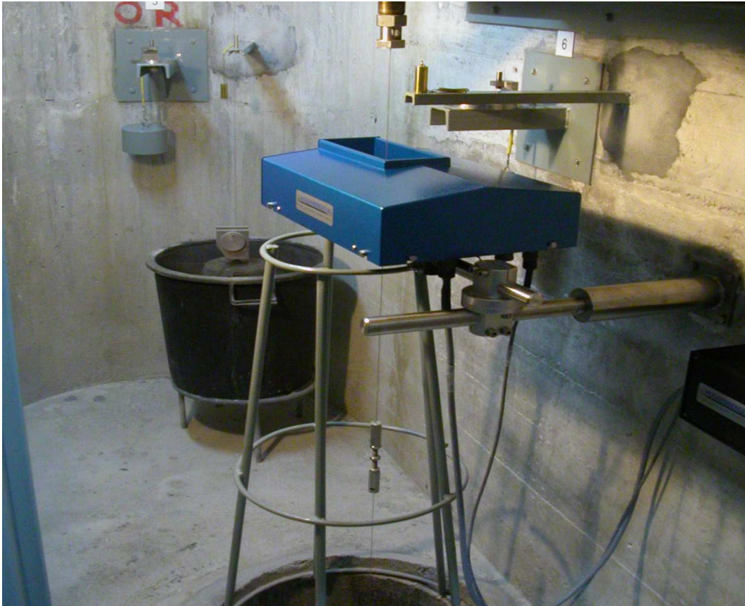
Figura 2.16 – Telecoordinómetro associado a um fio-de-prumo (Mata, 2005)
