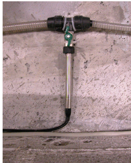
(b) Célula de pressão num ponto de medição
