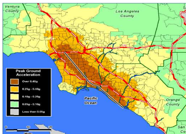
Figura 2.6 – Acção sísmica para um cenário que afecte o estado da Califórnia (Fonte: www.fema.gov )
