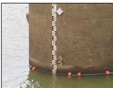
Figura 2.4 – Escala limnimétrica
