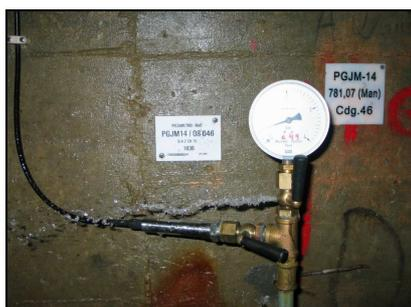
Manómetro de um piezómetro simples
