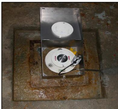
**Figura 2.8 – Cabeça de extensómetro de fundação**
