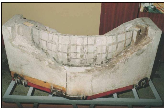
**Figura 2.12 – Modelo em argamassa, para ensaio à rotura**
