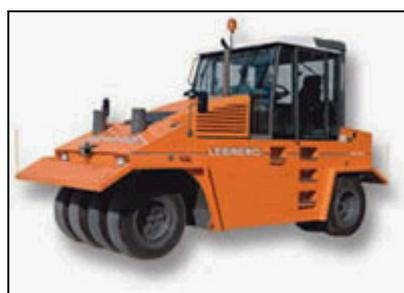
Fig. 3.18 – Cilindro de pneus
