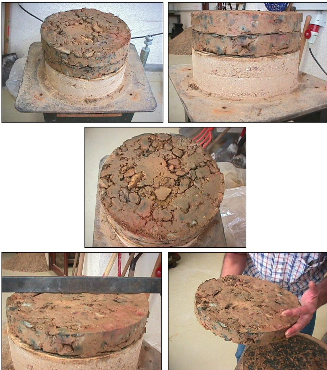
Fig. 5.11 – Provete com 40% de finos e 60% de grosso. Teor em água de 9%.
