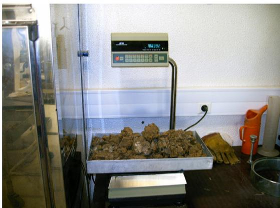
Foto. 13 – Pesagem do material para determinação do teor em água.
