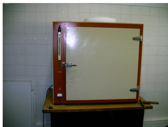
Foto. 18 – Estufa onde se coloca o material para determinação do teor em água.
