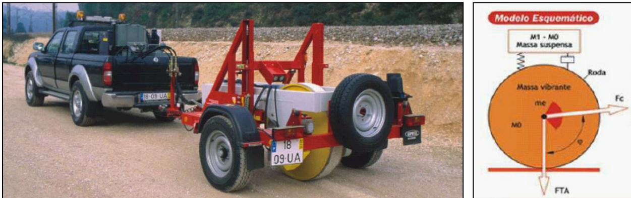
Fig. 4.14 – MCSC - Portancemètre (<http://www.geocontrole.pt>).
