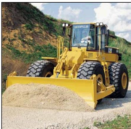
Fig. 3.6 – Tractor de rodas de pneus
