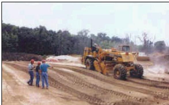
**Fig. 3.16 – Máquina do tipo “pulvimixer”**
