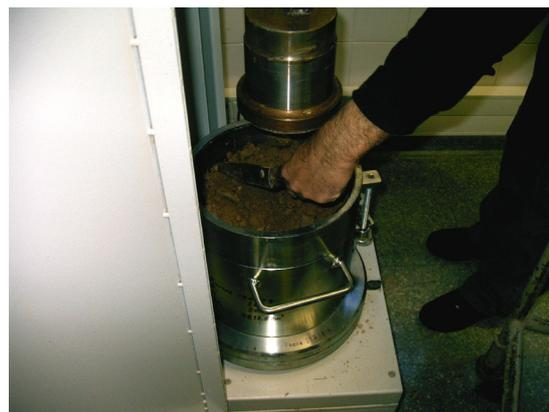
Foto. 8 – Colocação de uma camada de material dentro do molde do Proctor.
