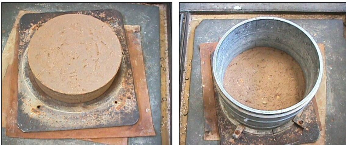
Fig. 5.7– Camada de base do molde.
