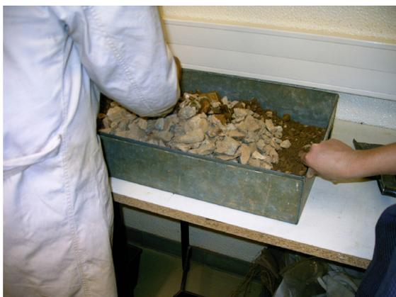
Foto. 3 – Mistura das várias fracções granulométricas.
