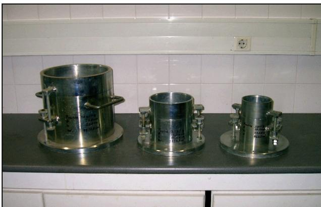
Fig. 5.13 – Moldes utilizados no compactador Toni-tecnik.
