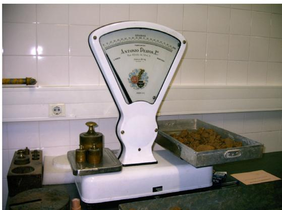
Foto. 7 – Pesagem do material constituinte de uma camada.
