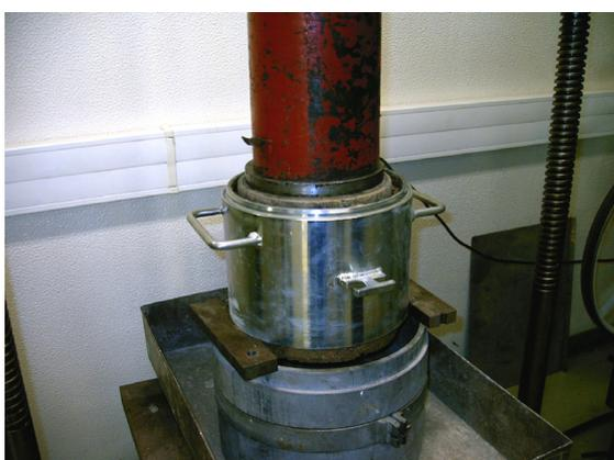
Foto. 11 – Extração do provete por intermédio de uma prensa.
