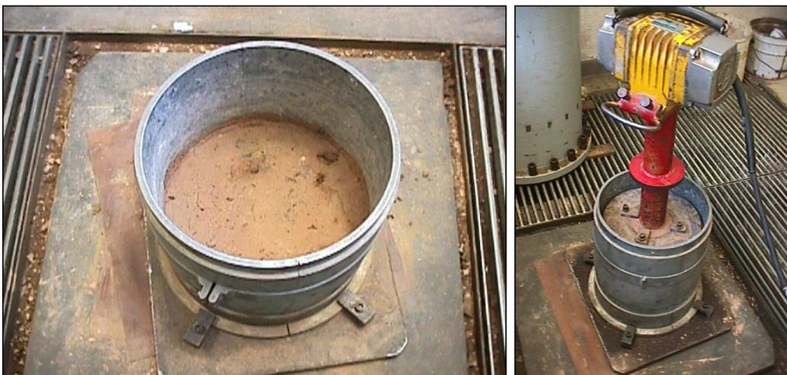
Fig. 5.4 – Molde colapsível com os dois aros aplicados. Fig. 5.5 – Molde e compactador mecânico.
