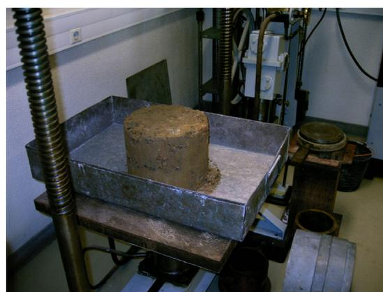
Foto. 12 – Molde após extração na prensa.
