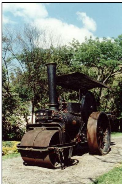
**Fig. 3.2 – Cilindro compactador movido a vapor**
