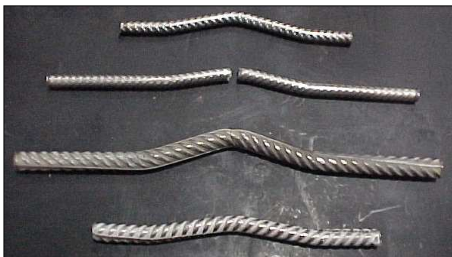
Figura 2-9 - Aspecto geral dos varões de aço inox após os ensaios cíclicos alternados.
