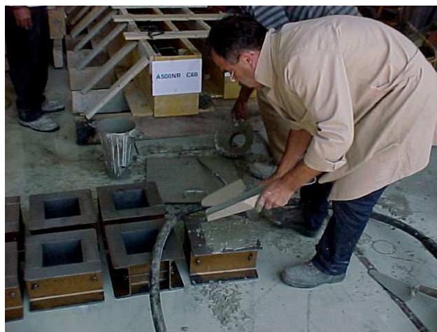
Figura 3-14 - Execução dos cubos.
