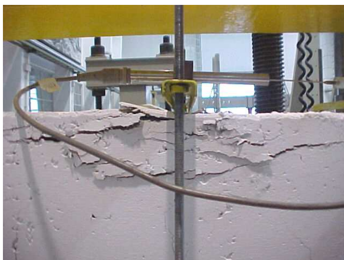
Figura 6-10 - Detalhe da rotura do betão em compressão na viga A500_C35_d16.
