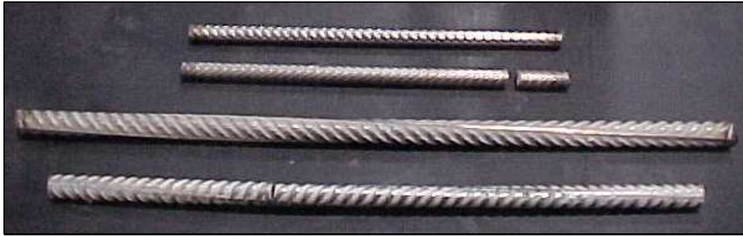
Figura 2-10 - Aspecto geral dos varões de aço inox após ensaio de fadiga.
