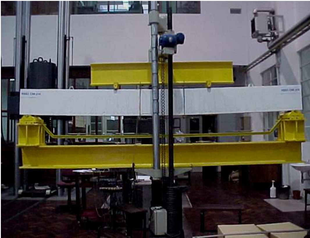
Figura 6-2 - Posição intermédia de ensaio da viga HSS3_C60_d14.
