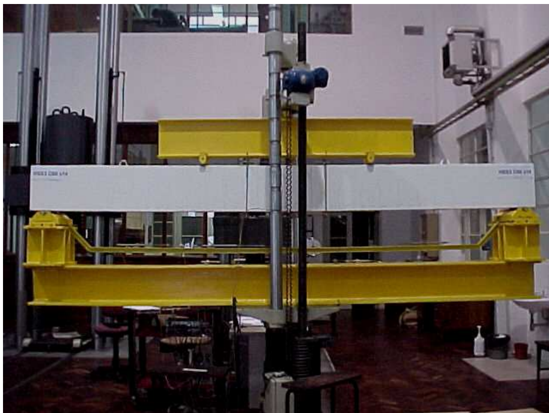
Figura 6-1 - Posição inicial de ensaio da viga HSS3_C60_d14.
