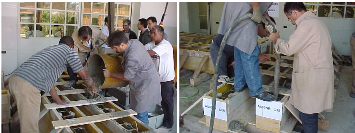
Figura 3-11 - Colocação e vibração do betão.
