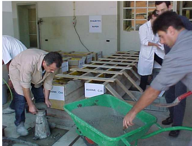
Figura 3-12 - Colocação do betão no cone de Abram's.
