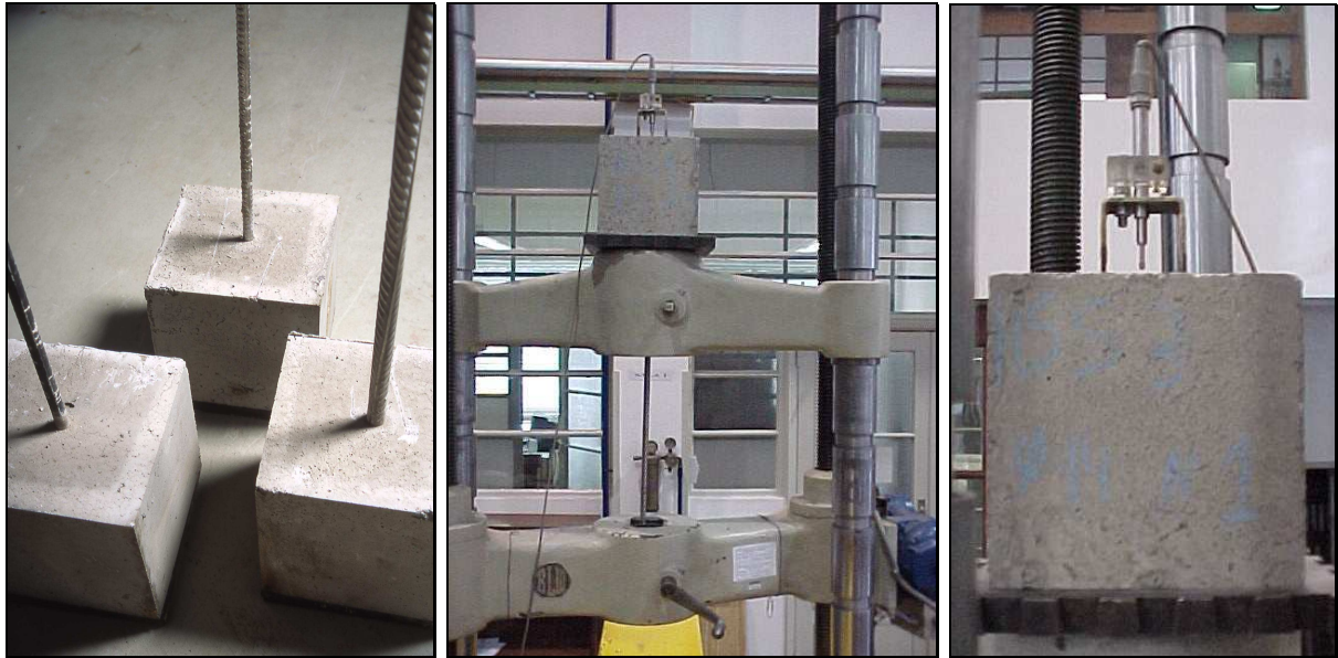
Figura 2-13 - Vista geral dos provetes, sistemas de ensaio e medição usados nos ensaios de pull-out .
