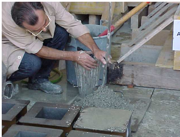
Figura 3-13 - Medição do abaixamento do cone de Abram's.
