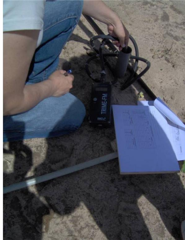
Fig. 6 - Aspecto da medição da humidade do solo
