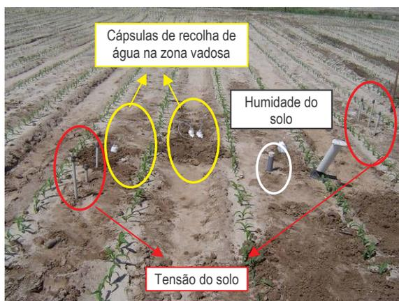
Fig. 11 - Dispositivos de medição de parâmetros na zona vadosa do solo em 2007
