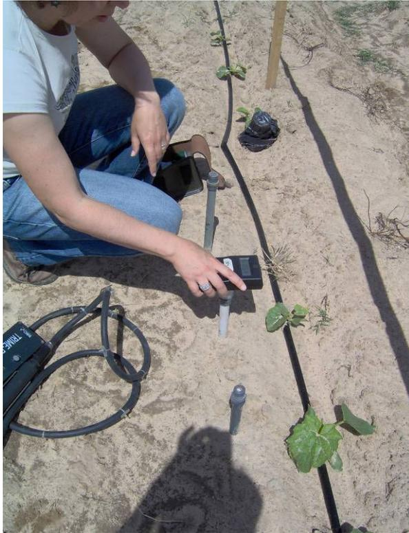
Fig. 5 - Aspecto da medição da tensão do solo
