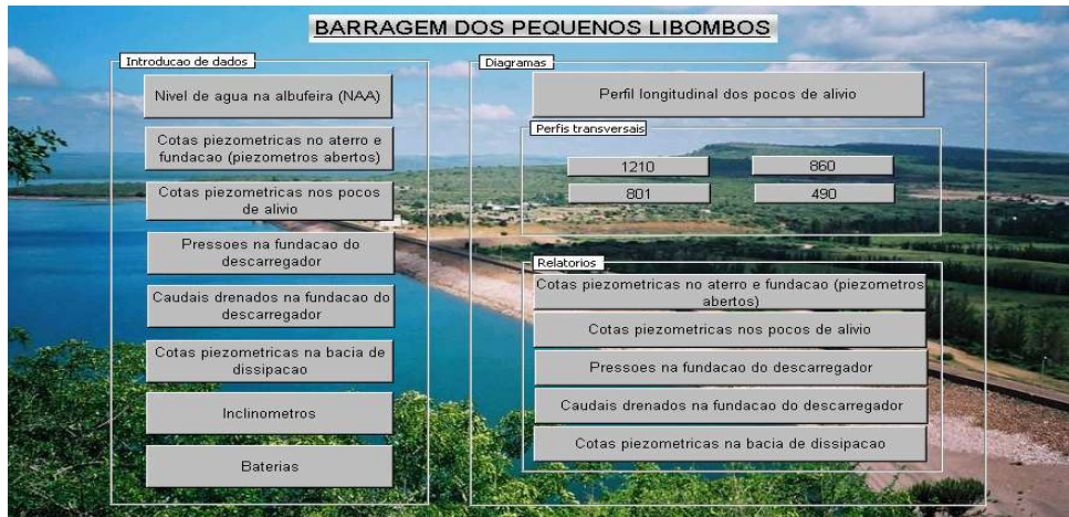
Fig 4-Janela de entrada no sistema de observação
