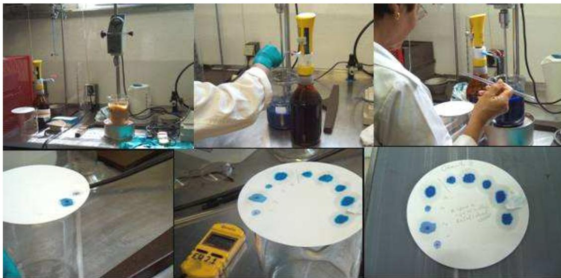
Figura 10 | Várias fases da realização do ensaio de azul de metileno
